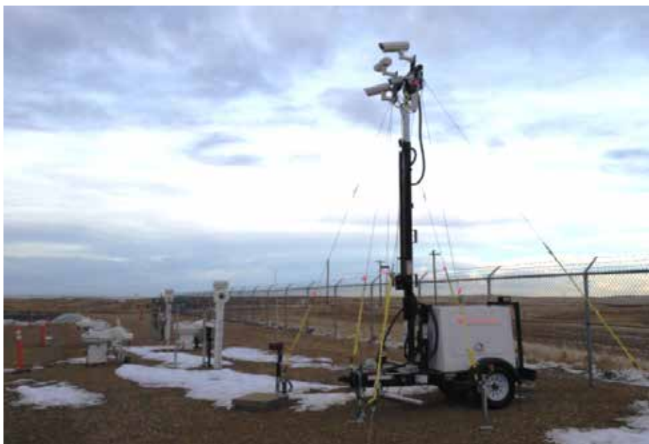
Remolque IntelliView sobre el terreno: El remolque integrado y resistente a las condiciones meteorológicas puede albergar múltiples unidades DCAM™ y opciones de electricidad verde (pilas de combustible y paneles solares). El DCAM ofrece una forma eficaz de detectar y alertar sobre pequeños vertidos en la superficie, pulverizaciones y encharcamientos en cuestión de segundos.
