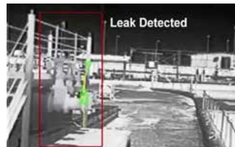
Gracias a la cámara térmica FLIR, el sistema DCAM es capaz de ofrecer resultados de detección de gran precisión con un índice de falsas alarmas extremadamente reducido.
