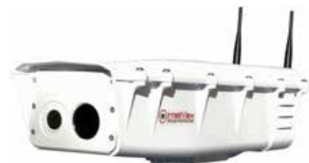
El DCAM™ (módulo analítico de doble cámara, por sus siglas en inglés) de IntelliView combina una cámara visual y una térmica FLIR que incorpora capacidades patentadas de análisis de fugas. Dentro de su campo de visión, el DCAM puede detectar una fuga de solo 6 litros por minuto en cuestión de segundos.
